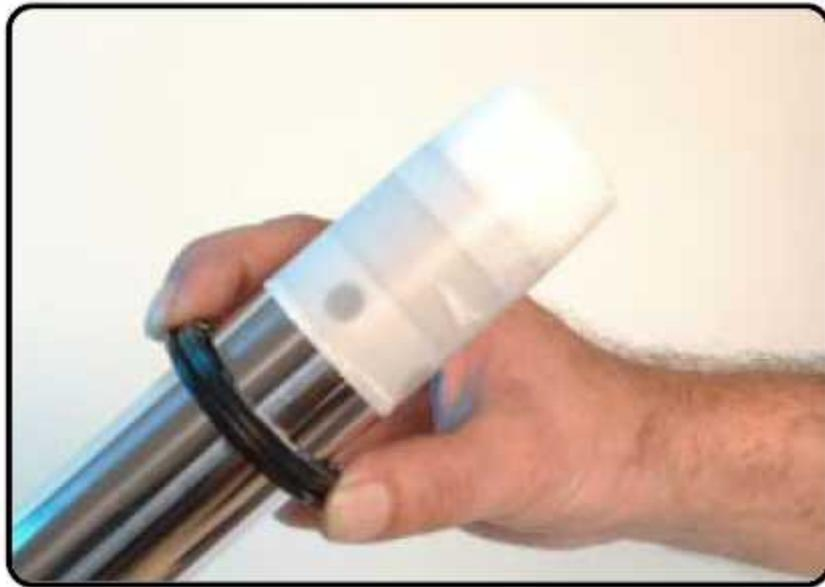
16. Una volta inseriti tutti i spessori possiamo re-infilare il fodero sullo stelo e inseriamo il paraolio nella sua scanalatura sul fodero stesso. Non riusciremo ad inserirlo a mano, ma almeno ora che è puntato possiamo passare alla fase successiva.
