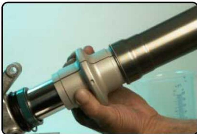
18. Ora inseriamo il fermo del paraolio **controllando che entri nella sua scanalatura** e poi unghiamo con un po' di grasso silconico il paraolio, il parapolvere e lo stelo. Inseriamo anche il parapolvere nel fodero e siamo a posto.
