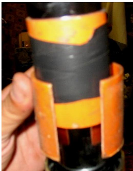
Fissate saldamente con del nastro l'anello + alto allo stelo della forcella
